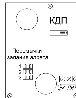
Рисунок 3 – Внешний вид платы КДП
